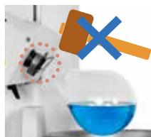
R-100ではフラスコ固定部品(コンビクリップ)を使って、長時間の減圧によって固着したフラスコも簡単に取り外せます。
